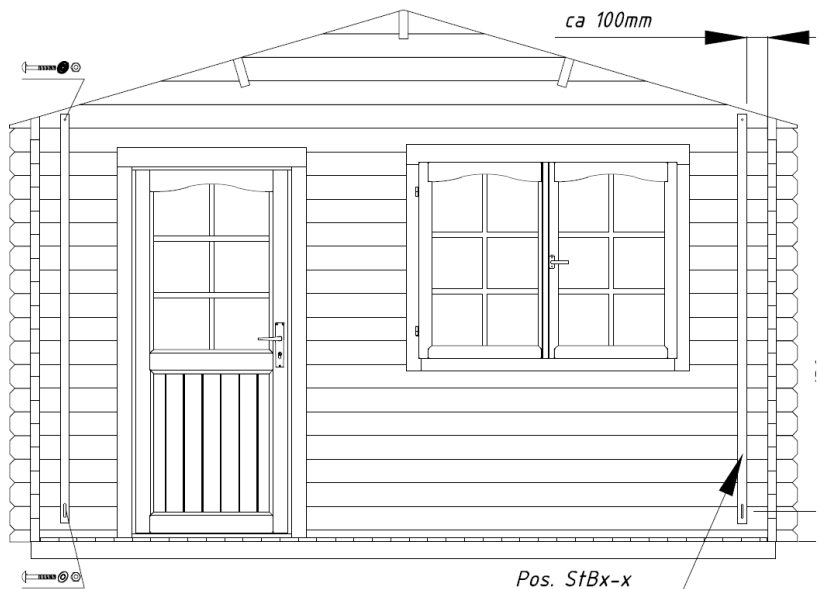
Installatie van de stormankers:
